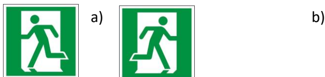
Rys. 3. Sposób umieszczania znaku „Drzwi ewakuacyjne”
