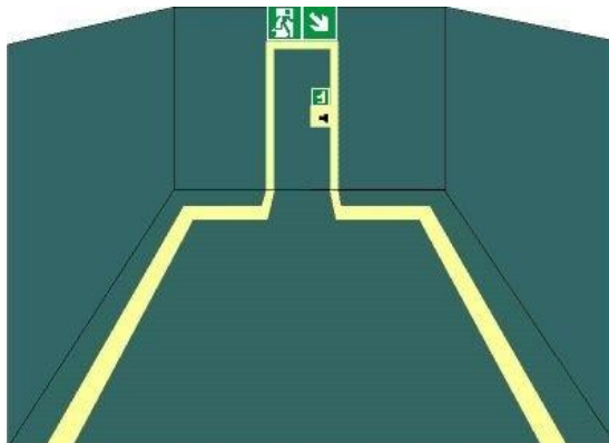
Rys. 16. Przykład dodatkowego oznakowania drogi ewakuacyjnej za pomocą pasów z materiału fotoluminescencyjnego umieszczonych na podłodze
